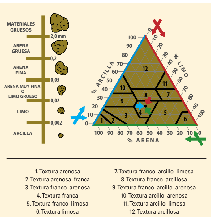
Figura 3.2. Diagrama triangular para la determinación de la textura
